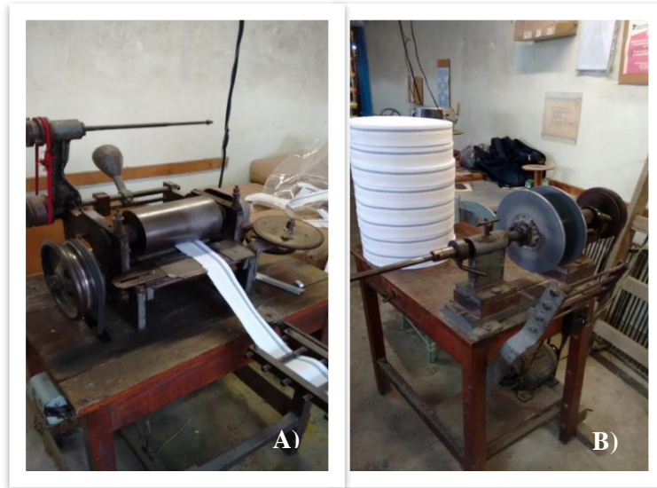
Imagen 3.23: A) Dispositivo de medición de cintas en sector plancha. B) Dispositivo de enrollado de cintas del sector plancha. Fuente: Imagen propia tomada con autorización de dirección.
