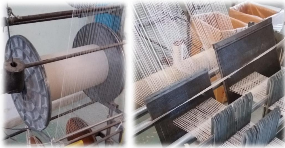
Imagen 3.11: Jaula trasera de telares de aguja. Fuente: Imagen propia tomada con autorización de dirección.
