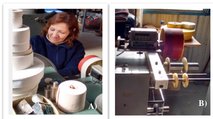
Imagen 3.22: A), B) Proceso de enrollado en sector de costura. Fuente: Imagen propia tomada con autorización de dirección.
