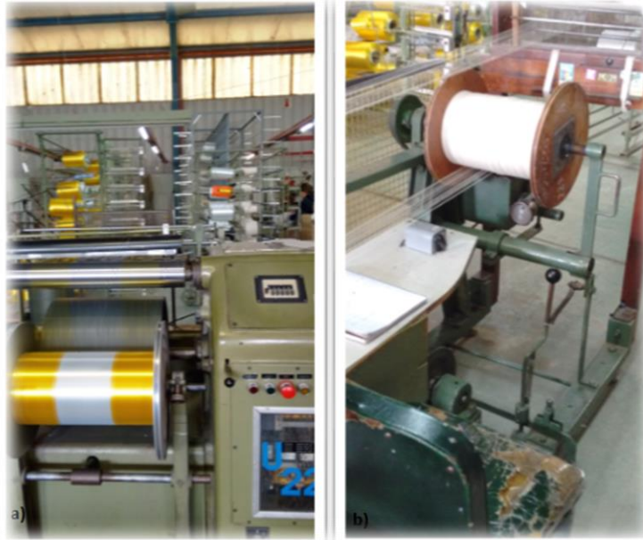
Imagen 3.3: a) Dispositivo de urdido U22.b) Dispositivo de urdido U23. Fuente: Imagen propia tomada con autorización de dirección.
