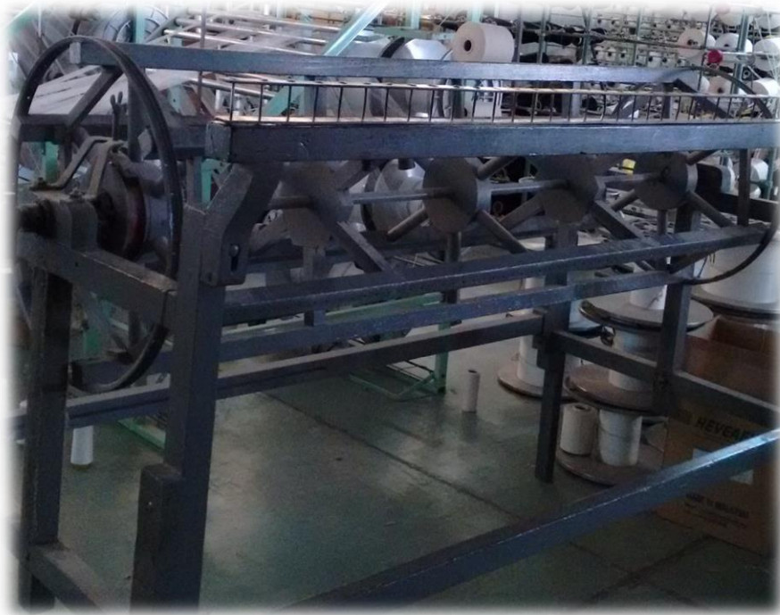
Imagen 3.8: Dispositivo separador de gomas de Manufactura Textil Alta Gracia. Fuente: Imagen propia tomada con autorización de dirección.
