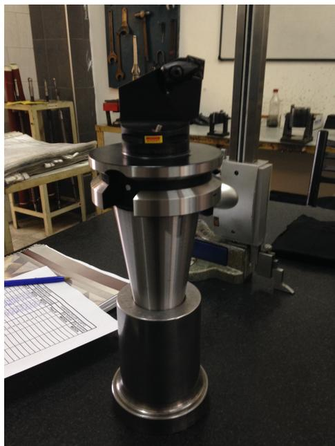
**Figura 3-26.** Cono Iso, porta capto y inserto utilizados en el ensayo.
