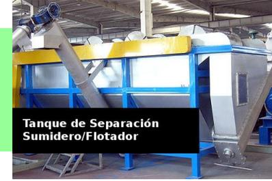
Tanque de Separación Sumidero/Flotador
