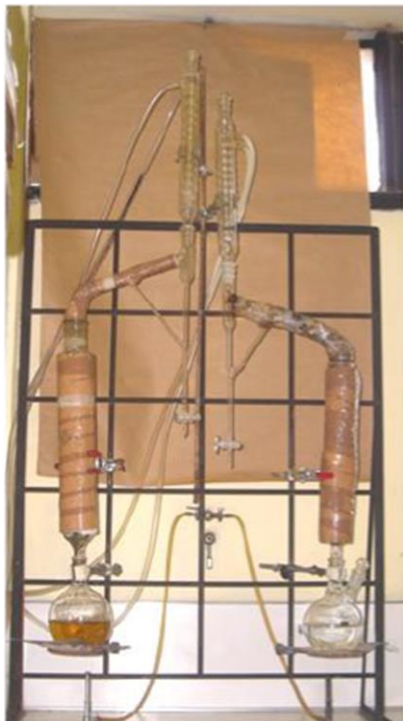
Figura 2. Destiladores tipo Clevenger utilizados para la extracción del AE de T. minuta .
