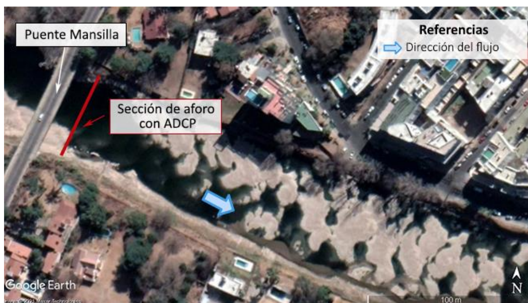
Figura 47.- Ubicación de la sección de aforo con ADCP en la zona 2 del río San Antonio.
