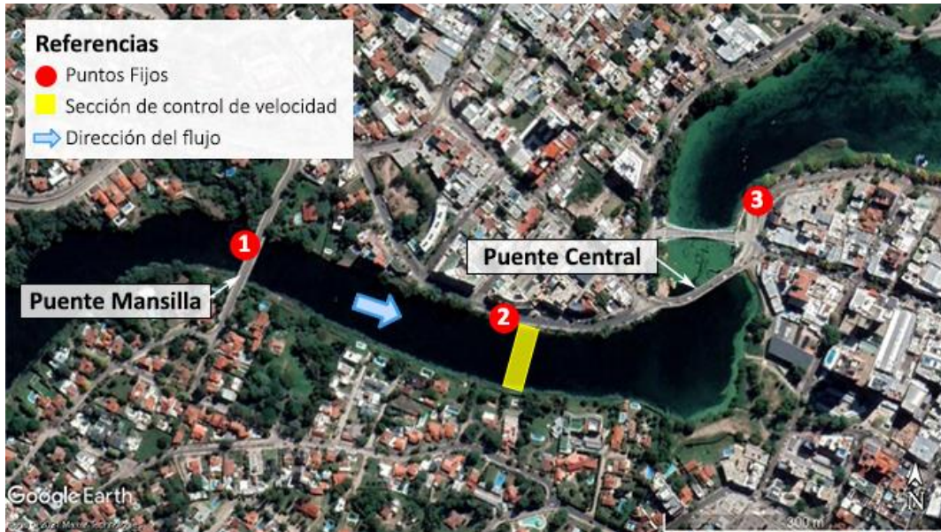
Figura 50.- Sección de medición de velocidades en el Río San Antonio y puntos fijos.
