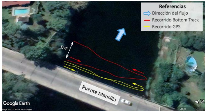
Figura 58.- Esquema del método del lazo con ADCP en la sección de estudio en el río San Antonio.
