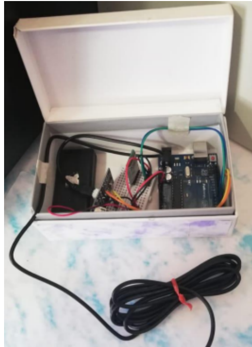
Figura N° 46: Transmisor: Sensor - Arduino
