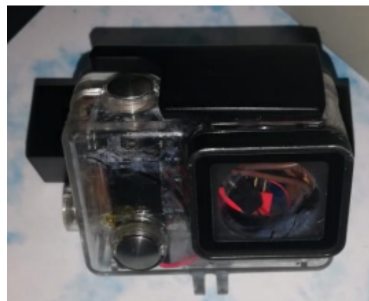
Figura N° 49: Electrónica dentro de un gabinete estanco
