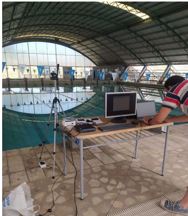
Figura N° 56: Módulo transmisor con cámara registrando imágenes de la pileta
