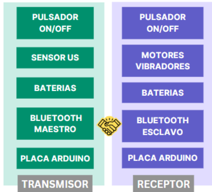
Figura N° 45 - Diagrama de bloques prototipo 2
