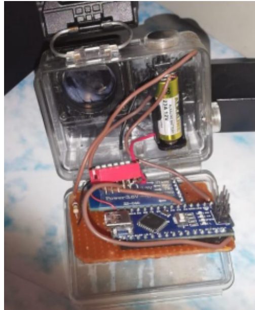
Figura N° 47: Receptor: Arduino - Bluetooth - Auriculares
