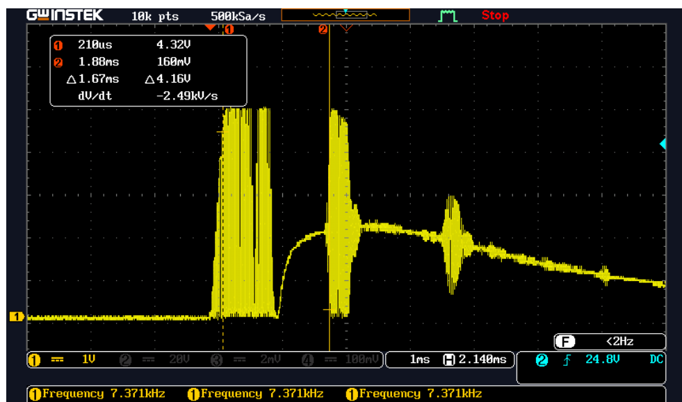
Figura N° 33: Onda de ultrasonido con obstáculo a 30cm
