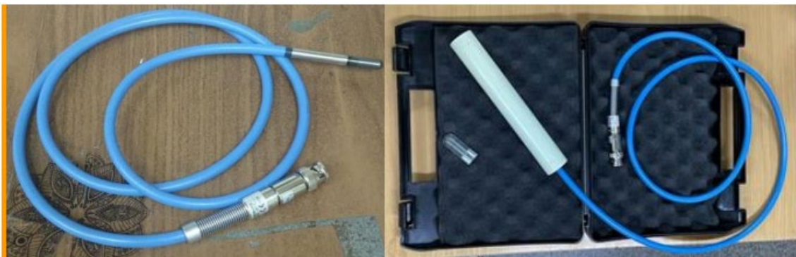
Ilustración 43 Cámara de ionización PTW TN31003 del Hospital Oncológico de Córdoba.
