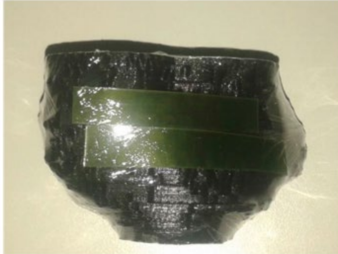
Ilustración 38 Vejiga con placas radiosensibles pegadas. [54]
