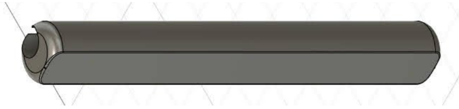
Ilustración 61 Modelo de porta cámara de ionización (hueco circular) y placa radio-crómica (lado plano).
