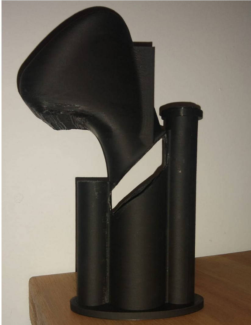
Ilustración 65 Maniquí con ventana para visualización del aplicador. Sin vejiga montada.
