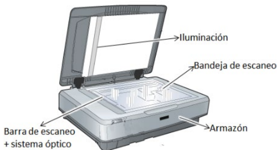
Ilustración 30 Partes más importantes de un escáner. [47]
