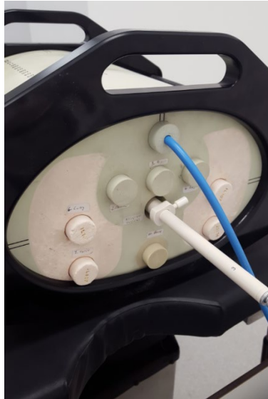
Ilustración 16 Maniquí CIRS durante un control E2E.
