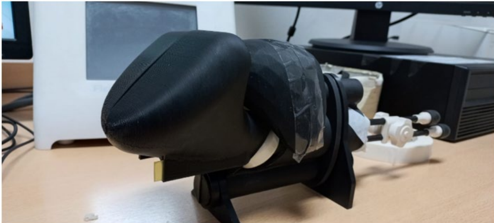
Ilustración 90 Maniquí armado para medición con placas radio-crómicas.
