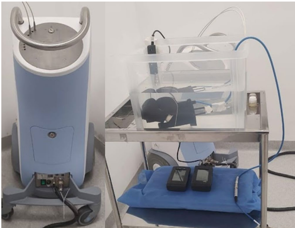
Ilustración 80 Máquina de poscarga a la izquierda. Maniquí armado para recibir tratamiento a la derecha.
