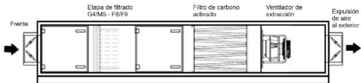
Figura 22: Diagrama de un equipo de extracción de aire tratado con filtro F8/F9
