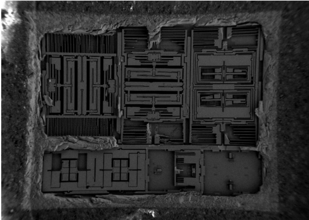
Figura 29. MPU6050 en microscopio
