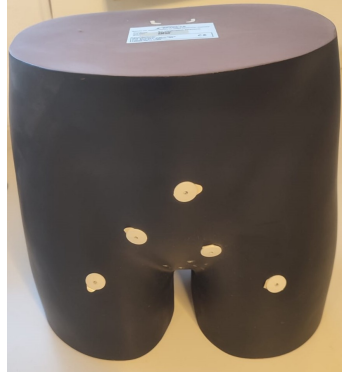
Figura 3.2: Fantoma de pelvis utilizado para el protocolo TG 119
