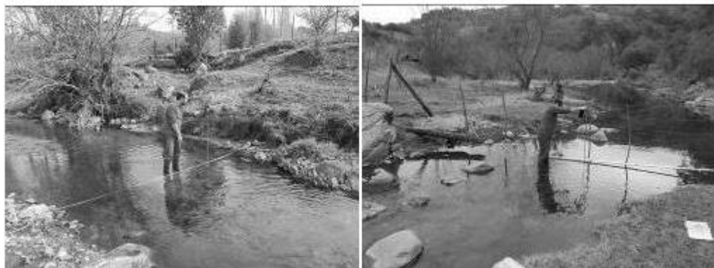
Figura 6. Medición de velocidades en las secciones de aforo 1 y 2.
