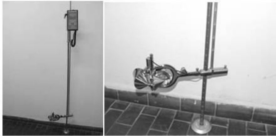
Figura 5. Molinete de eje vertical Modelo 6215 USGS Tipo AA-MH Tipo AA
