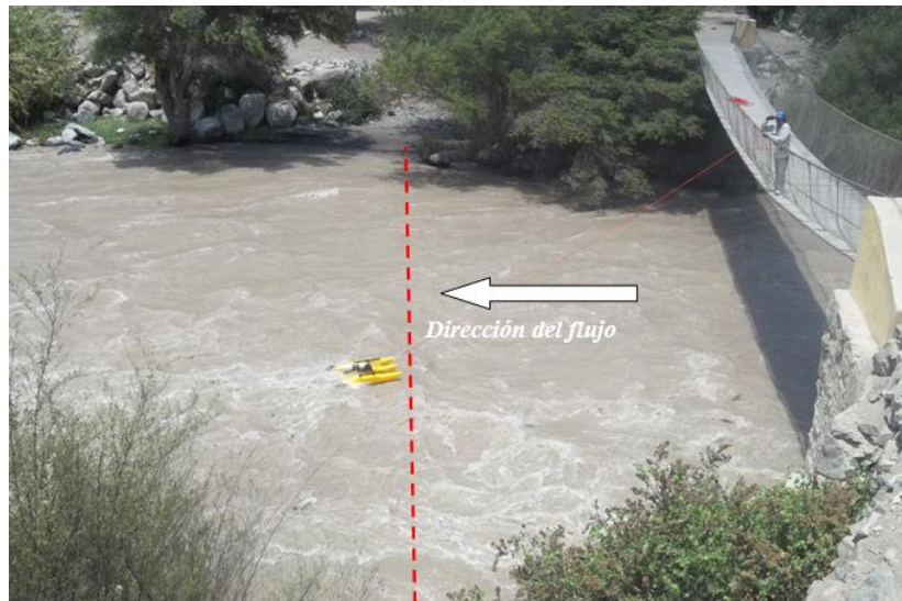
Figura 7. Aforo de caudal en sección Letrayoc – 29/01/2015
