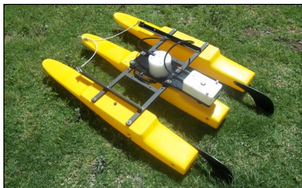
Figura 3. ADCP M9 montado en la plataforma móvil
