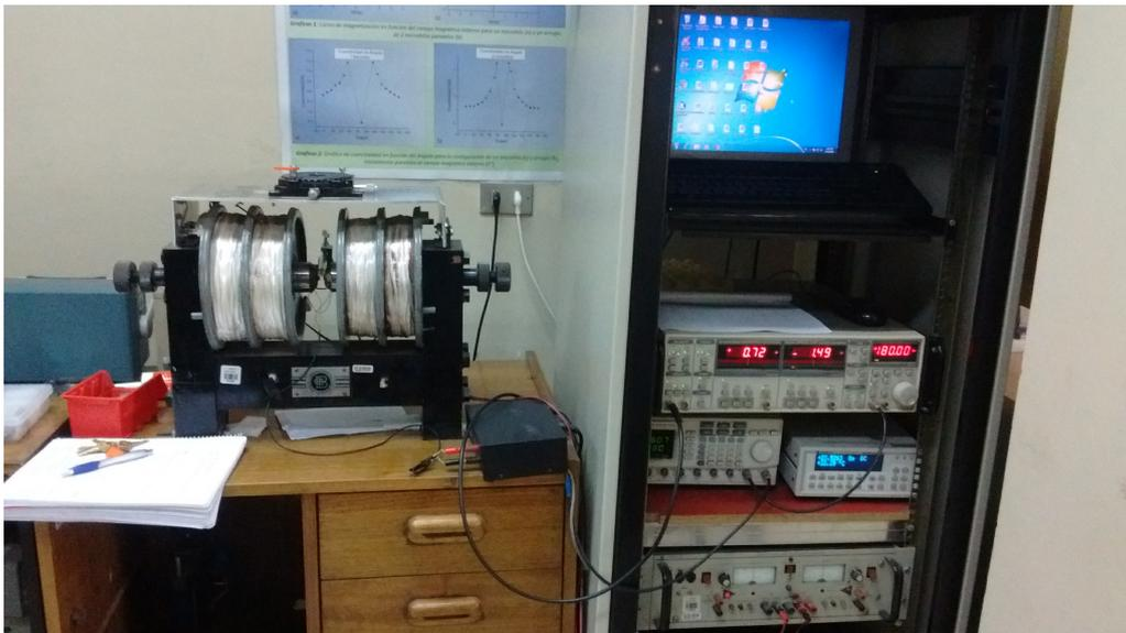
Figura 4.13: Fotografía del magnetómetro de gradiente de campo alterno del CEDENNA.
