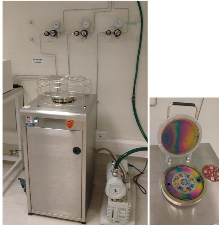
(a) ALD junto con receptáculo de precursores. (b) Cápsula donde se realiza la deposición.
