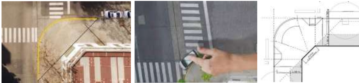
Fig. 10: Planta de esquina con Curva de Línea Cordón Vereda, rampas de acceso discapacitados y sendas peatonales. Normativa de la Municipalidad de Villa María. Fig 11. Vista Aérea: en línea amarilla curvatura de L.C.V., en blanco Sendas peatonales sobre calzada vehicular y en línea de puntos negra: trazado de ochava. Fig. 12: giro del automóvil en límite de calzada y vereda.
