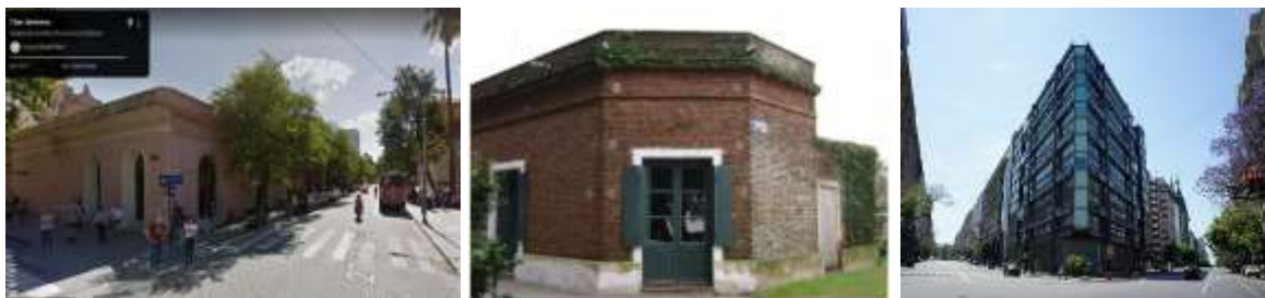
Fig. 5: Antigua construcción en esquina de la ciudad de Córdoba sin ochava (Recova esquina calles Independencia y 27 de Abril, Fuente Google Maps). Previamente a 1821, las construcciones no poseían ochava, generando dificultades en el diseño de la vereda, en el tránsito y la seguridad. Fig. 6: Ejemplo de terreno en esquina con construcción italianizante respetando ochava. Fig. 7: Edificio Somisa, Bs.As. Mario Roberto Álvarez y asociados, hace de la esquina y la ochava una idea generadora de su proyecto.
