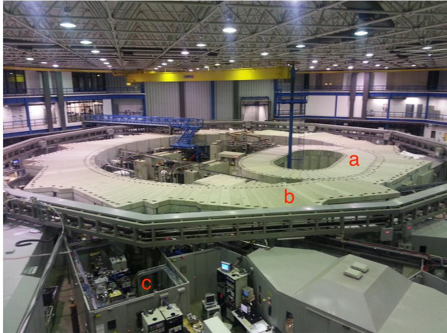
Figura 2.3: Partes de un sincrotrón. a.) *Booster* b.) Anillo de almacenamiento c.) Línea de operación. Fotografía del sincrotrón del *Laboratório Nacional de Luz Sincrotrón*, Campinas, Brasil tomada en octubre del 2013.
