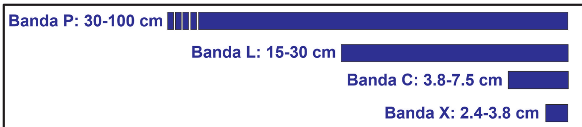
Figura 2.8: Longitudes de onda para bandas de frecuencia típicas de los sistemas SAR (adaptado de [40]).
