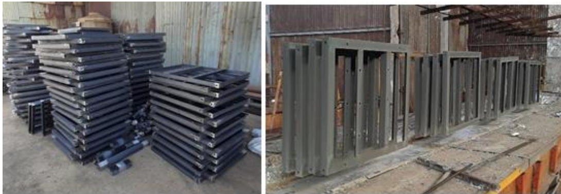
Figura 4.2: Los cuadros a tratar dispuestos como los entrega el cliente y por ser sumergidos en el zinc fundido.
