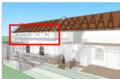
Imagen 19: posición de los mechinales en la reconstrucción virtual de la capilla.
