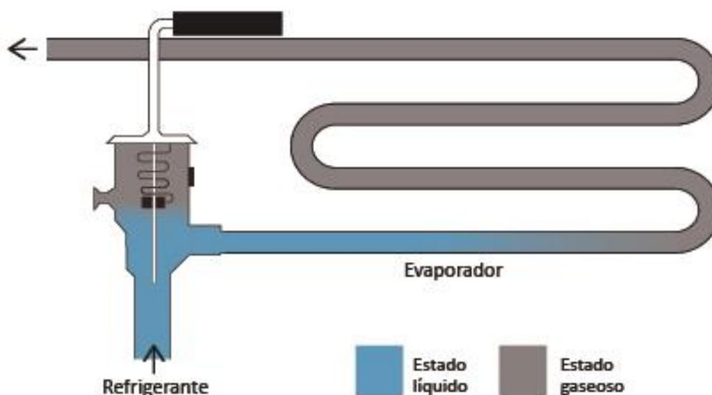
Imagen 18 - Capítulo III - Esquema básico de la válvula de expansión
