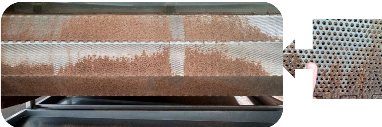
Imagen 4.2: Detalle de la cinta transportadora del horno túnel.
