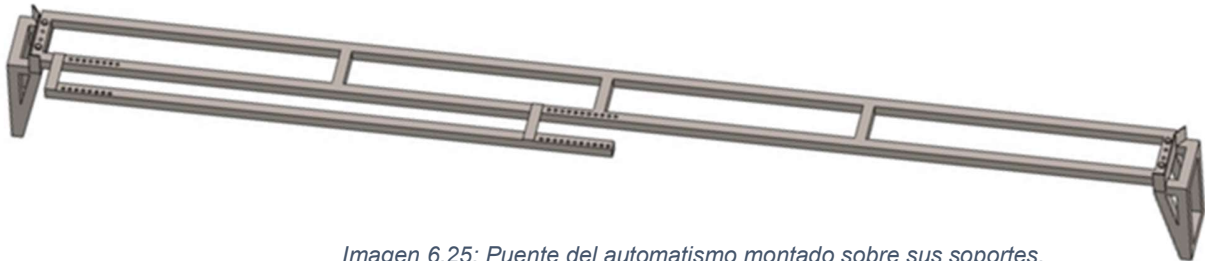
Imagen 6.25: Puente del automatismo montado sobre sus soportes.
