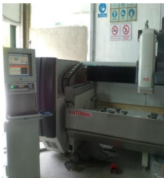
FIGURA 4.13 - Maquinaria para pulir bordes de la empresa Templados Centro SRL. Fuente: elaboración propia.
