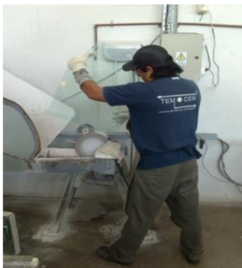
FIGURA 4.12 - Pulido de bordes manual. Fuente: elaboración propia.
