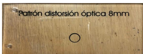
FIGURA 5.30 - Patrón de comparación (D = 8 mm) utilizado por la empresa Templados Centro SRL. Fuente: Elaboración propia.
