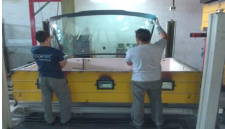
FIGURA 4.19 - Colocación de parabrisas en matriz del horno de curvado. Fuente: elaboración propia.
