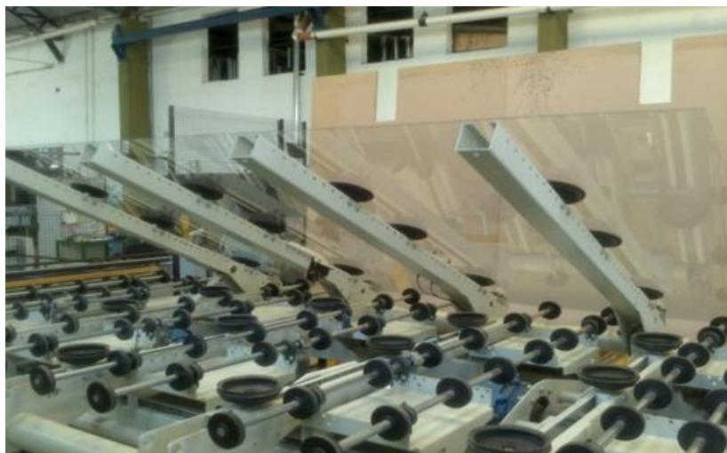
FIGURA 4.3 - Máquina cargadora en área de corte de la empresa Templados Centro SRL. Fuente: elaboración propia.
