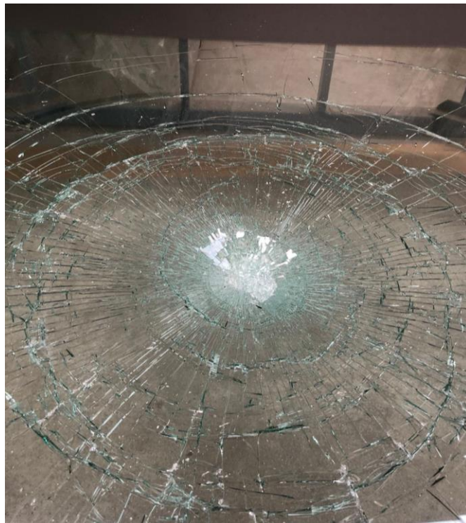
FIGURA 5.45 - Parabrisas luego de ser impactado por cabeza phantom - Imagen ampliada. Fuente: Elaboración propia.
