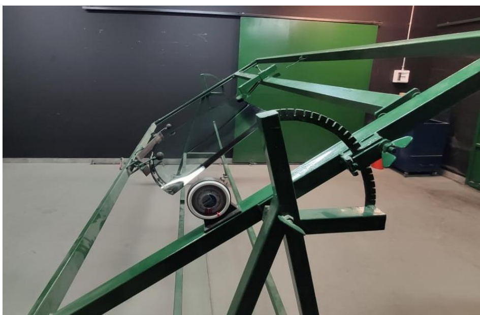
FIGURA 5.32 - Colocación de parabrisas sobre soporte con ángulo de inclinación correspondiente. Fuente: Elaboración propia.
