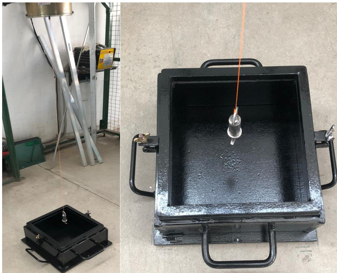
FIGURA 5.19 - Utilización de plomada para centrar dispositivo de apoyo. Fuente: Elaboración propia.
