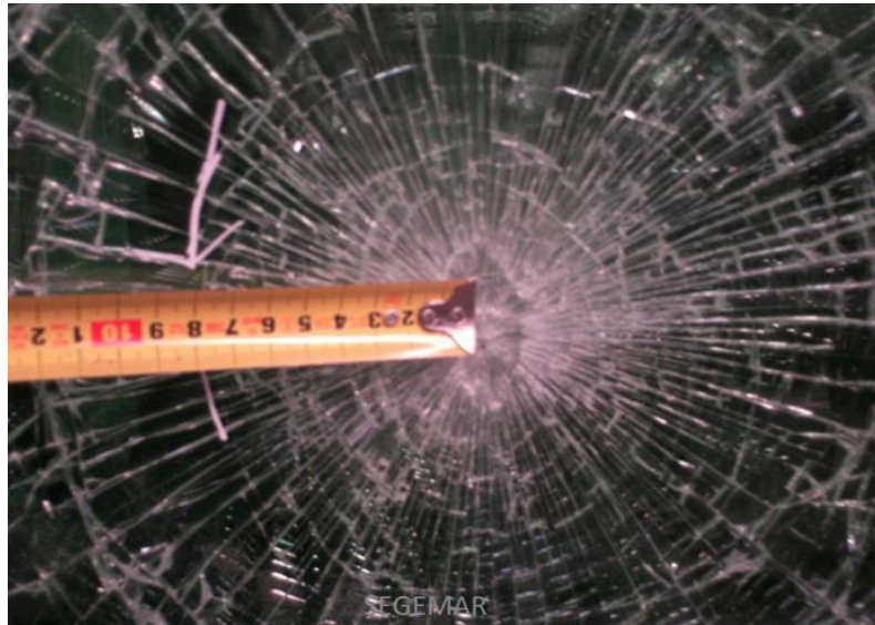
FIGURA 5.47 - Fisura de parabrisas por debajo de los 80 mm del punto de impacto. Fuente: Elaboración propia.
