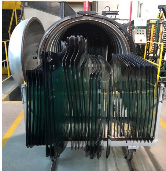
FIGURA 4.26 - Carros de autoclave utilizado en la empresa Templados Centro SRL. Fuente: elaboración propia.
