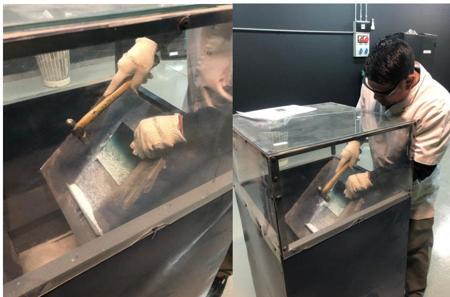
FIGURA 4.50 - Ejecución de golpes sobre probeta en ensayo de pummel. Fuente: elaboración propia.
