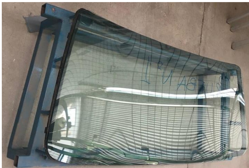
FIGURA 5.42 - Colocación de parabrisas sobre dispositivo de apoyo. Fuente: Elaboración propia.
