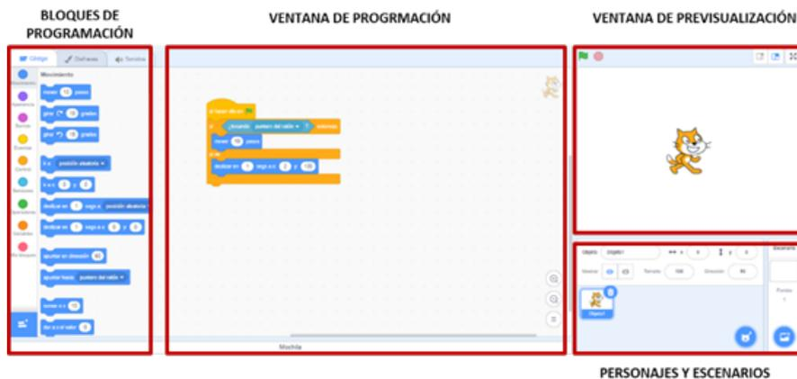
Figura 1. Principales componentes del entorno de programación por bloques Scratch
