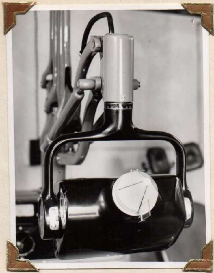
Fig. Nº 18. Parte del guión indicador (D) del aparato Ortholator colocado en el foco del aparato de rayos.-
