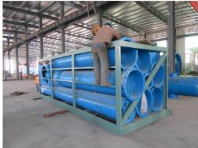
Usar un marco de acero para arreglar el equipo de acero
