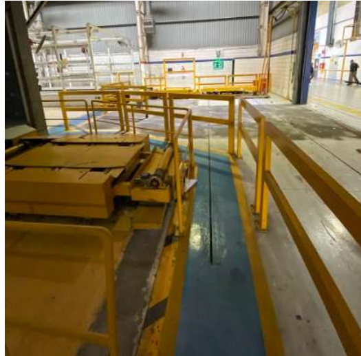
Figura 4.56: “Carril de desplazamiento”
