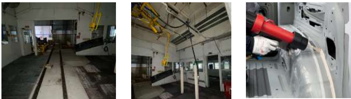
Figura 4.8: “Área de Aplicación de PVC”
