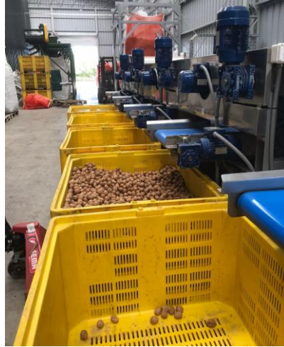
Imagen 4.22. Bins a la salida de la clasificadora según diámetro ecuatorial.
