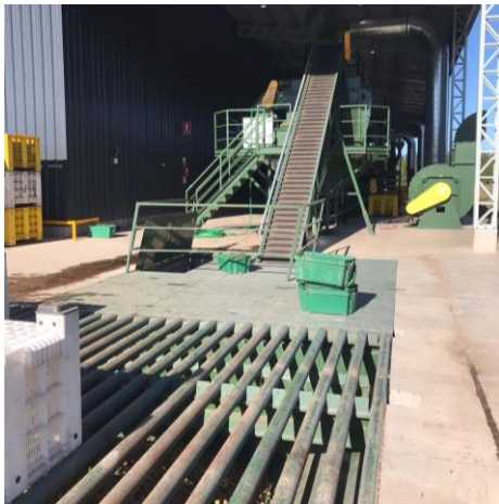
Imagen 4.8. Pozo de Depósito de Nueces y Cinta Transportadora.
