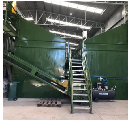
Imagen 4.19. Cinta transportadora que une los cajones con la vaciadora.
