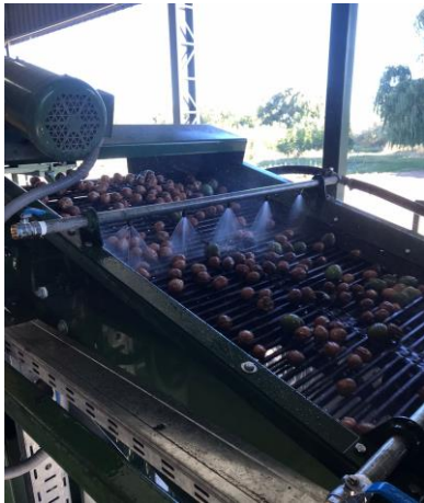
Imagen 4.10. Primera Limpieza con agua a alta presión
