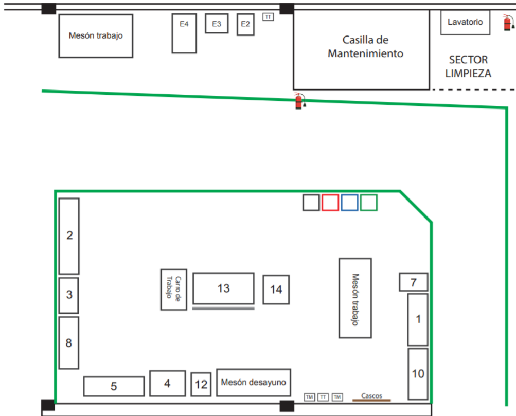
Figura 49. Nuevo layout de mantenimiento. Fuente: elaboración propia
