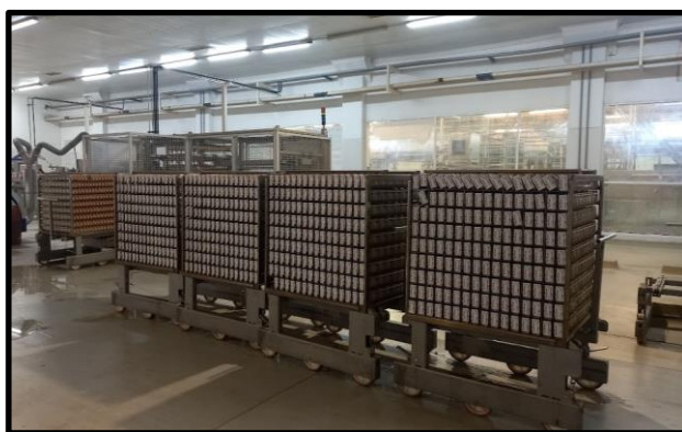
Figura 4.24: Espera de producto para descarga de racks
