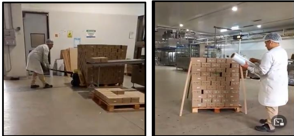
Figura 4.30: Traslado de pallet y colocación de esquineros
