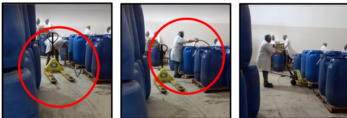
Figura 4.14: Obstrucción por manguera y colocación de zorra
