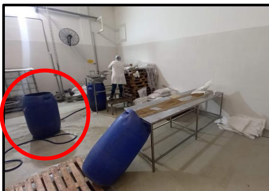
Figura 4.6: Área de trabajo obstruida por tacho con granos
