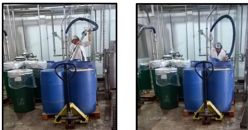
Figura 4.16: Colocación de bomba diafragma en tacho
