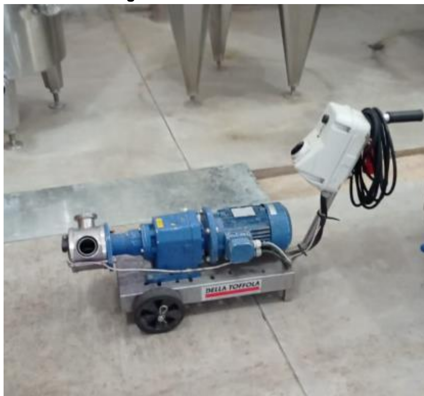
Figura 8.8: Bomba de mosto. 49
