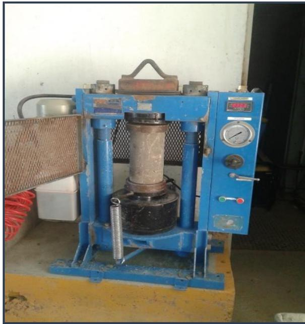
Imagen 6.5 Prensa del ensayo de rotura
