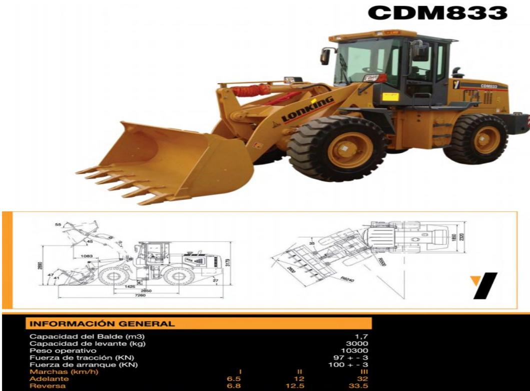
Imagen 7.3 Especificaciones cargador frontal Lonking CMD833
