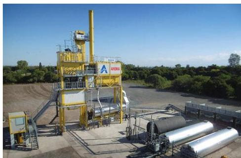
Imagen 2.3 Planta asfáltica Be Tower tipo discontinua
