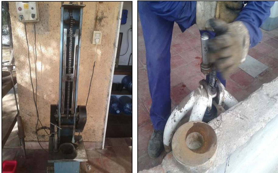
Imagen 6.18 Equipo de compactación y de extracción
