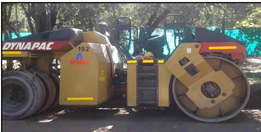
Imagen 5.11 Vibrocompactador de rodillo liso Dynapac
