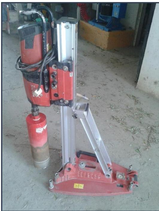
Imagen 6.6 Equipo para extracción de testigo
