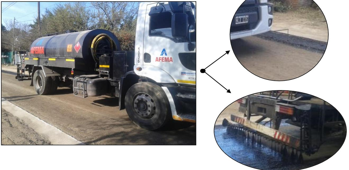
Imagen 5.19 Equipo imprimador. Distribuidores. Guía del operador
