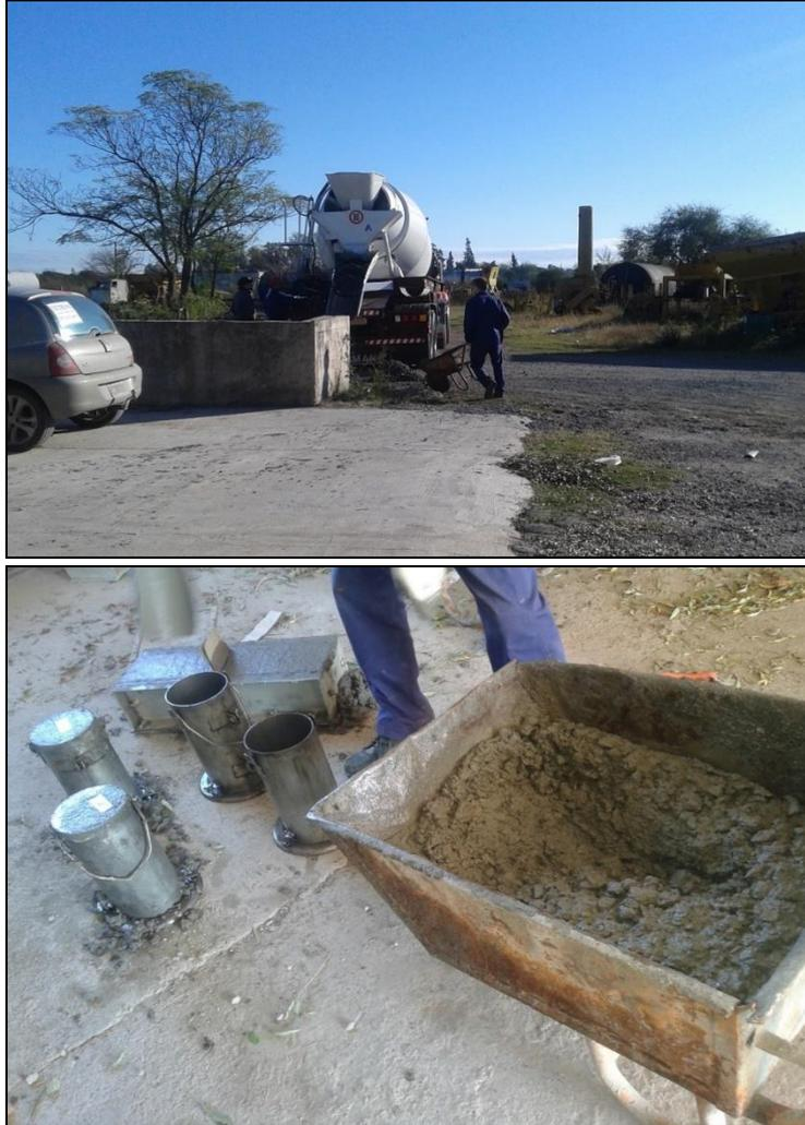
Imagen 6.3 Moldeo de probetas en laboratorio
