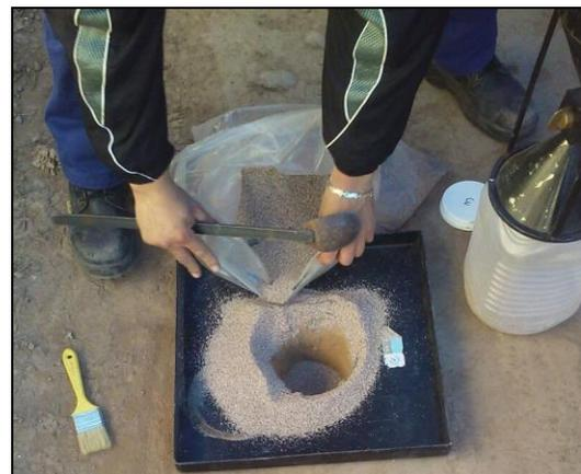
Imagen 6.1 Control de compactación por el método de la arena
