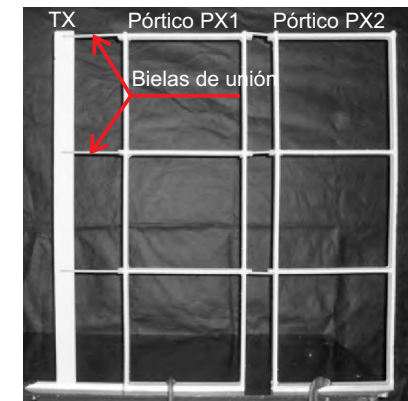
Figura 2 - Planos verticales en dirección X
