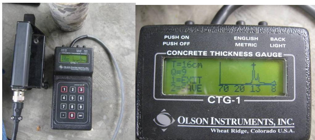
Figura 8. Equipo empleado para medición de la velocidad de propagación de ondas
