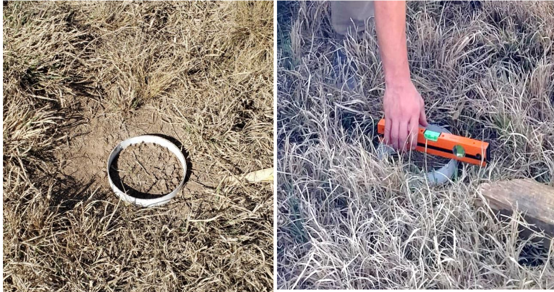
Figura 2a (izquierda). Aro metálico enterrado 5 cm. 2b (derecha) nivelación horizontal del anillo.
