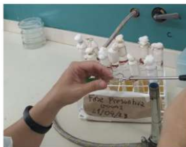
Fig 3: siembra de coliformes totales por método NMP en medio presuntivo CLS
