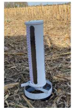
Infiltrómetro de simple anillo.
