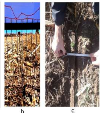
Figura 2. a) Gráfico de la perfilometría. Muestra el espesor de rastrojo de maíz, la zona limpia de tránsito y la profundidad de cuchilla. b) Foto del perfilómetro y el registro. c) Huella del abridor y ruedas de control.
