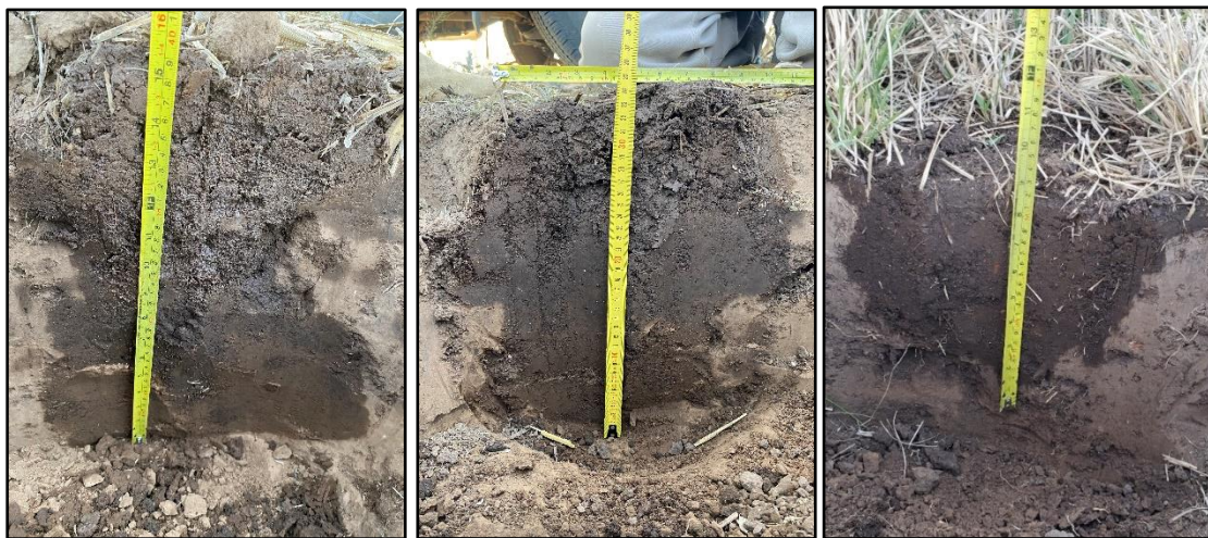
Figura 4. De izquierda a derecha, pozo de observación donde se evalúa el frente de humectación en los tratamientos 1, 2 y 3 respectivamente.
