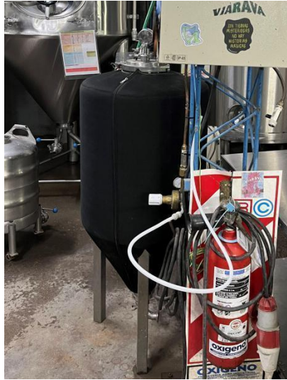
Figura 10. Fermentador de 100 litros para realizar pruebas.
