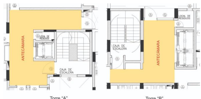
Figura 3.1.10.1 Antecámaras escaleras planta baja
