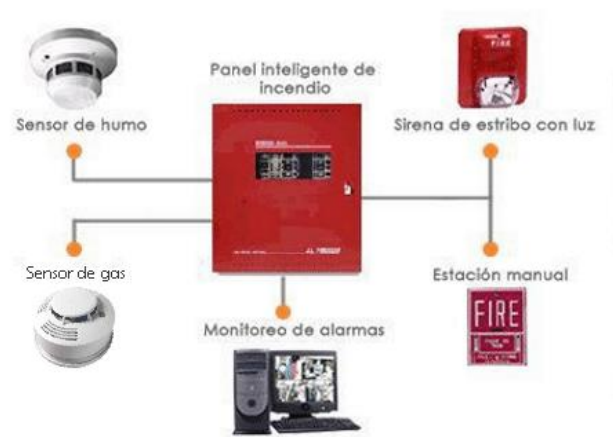
Figura 3.2 Sistema de detección de incendio y alarma
