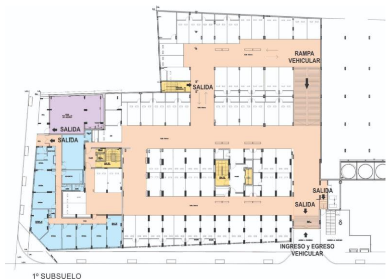
Figura 3.1.1 Condiciones de Evacuación
