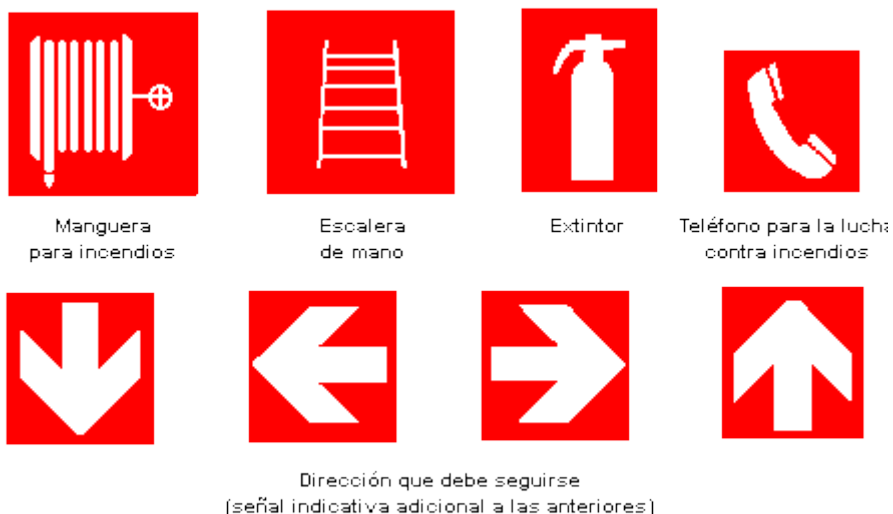
Ilustración 30 - Señales de Equipos Contra Incendios
