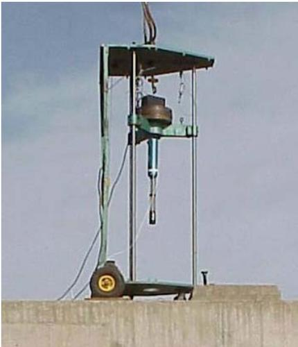
**Figura 5.** Soporte metálico para la aplicación de impulso sobre el tablero.
