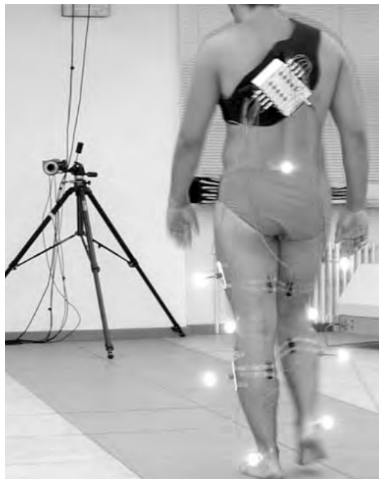
Fig. 14. Ejemplo de utilización de marcadores reflectantes. [15].
