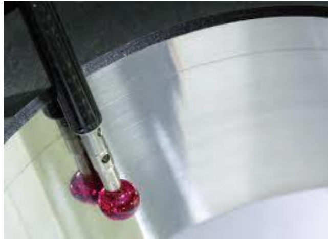
Ilustración 1.5. Estilete y palpador de una MMC midiendo una pieza.
