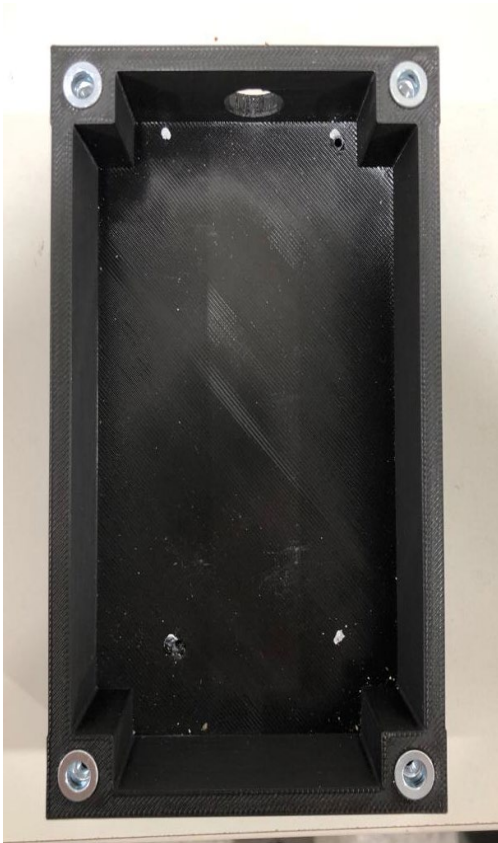
Ilustración 38 Caja realizada con impresión 3D
