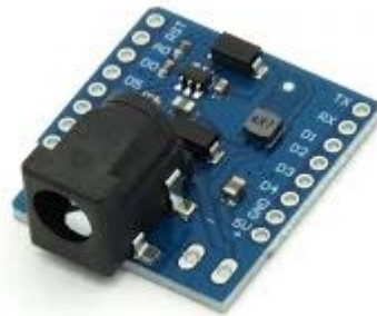
Ilustración 34 Power DC shield
