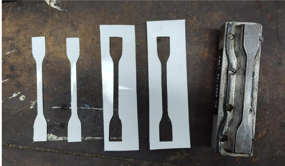
*Figura 10: Probetas de aluminio cortadas por medio de troquelado a partir de láminas*
