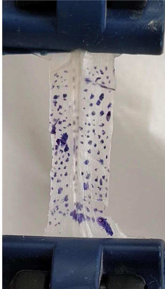
*Figura 41: Muestra de espina N°2 después de alcanzar la ruptura del material en el ensayo.*
