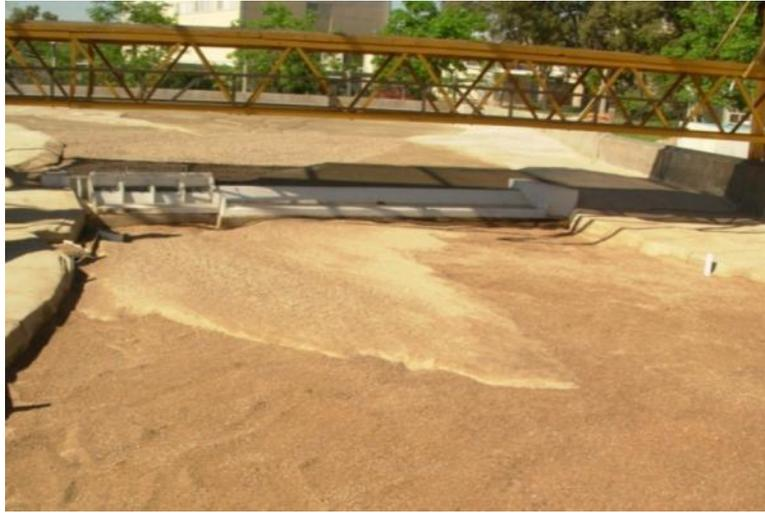
**Figura 4.-**Barra de sedimentos aguas abajo del foso de erosión, ensayo N°1 – 900 m<sup>3</sup>/s.
