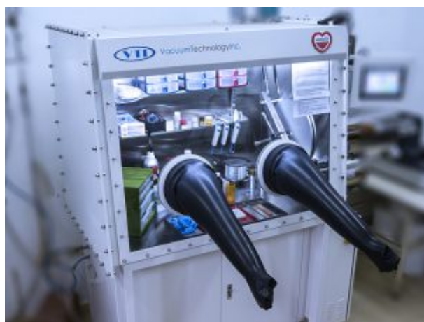
Figura 2.10: Fotografía de la caja de atmósfera controlada (GloveBox Vacuum Technology Inc. Modelo Super 1220/750/900) perteneciente al Laboratorio de Energías Sustentables, FAMAFA, UNC.
