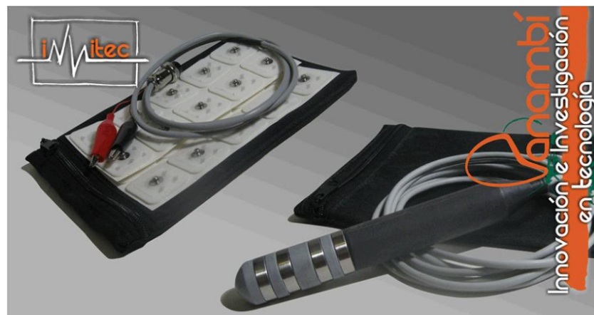
Fig. 6. Cableado y accesorio electrodo, de Panambí, equipo de electro estimulación.
