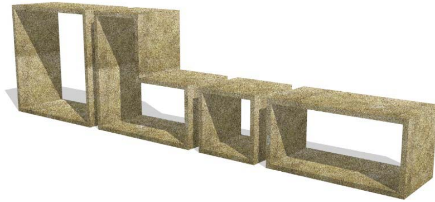
FIG 145: MODULOS DE TAMAÑOS DIFERENTES CON CASCARAS DE MANI Y RESINA POLIESTER
