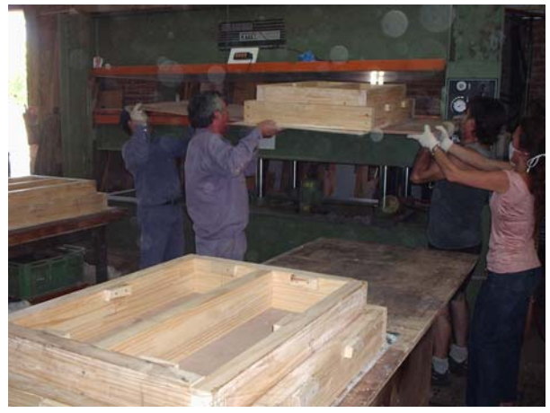
Fig 159: Elaboración experimental de tableros de cáscaras de maní en presa de platos calientes Fig 159e: Moldes de placas. Fig 159f: Colocación de moldes en prensa
