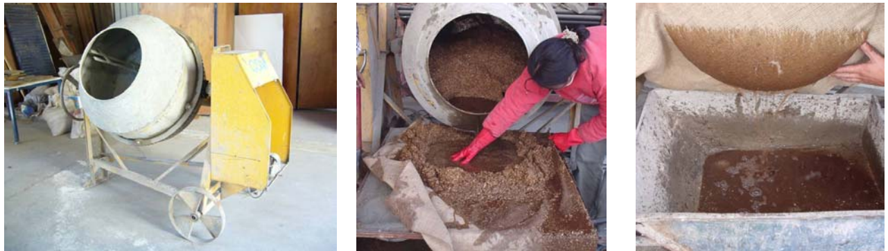
Fig. 54: PROCESADO DE CASCARAS DE MANI. Fig 54 a: Mezcladora tipo perita, Fig 54b: Filtrado de las cáscaras de maní después del lavado, Fig 54c: Extracto obtenido del lavado
