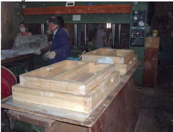
Fig 159: Elaboración experimental de tableros de cáscaras de maní en presa de platos calientes Fig 159e: Moldes de placas. Fig 159f: Colocación de moldes en prensa
