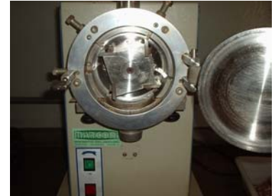
Fig. 43: Molino de cuchillas. 43a: Vista general 43 b: Vista de las cuchillas
