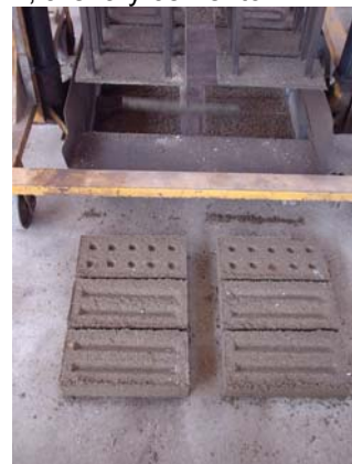
Fig 59: Ladrillos de cáscaras de maní, arena y cemento
