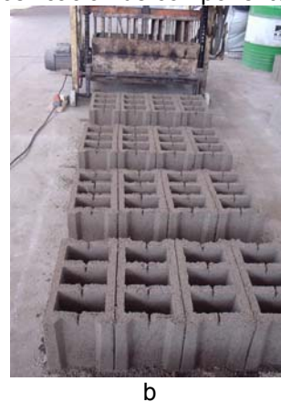
Fig. 57 a y b: Bloques de cáscaras de maní, arena y cemento
