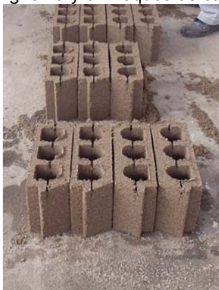
Fig 58: Bloques para techo de cáscaras de maní, arena y cemento
