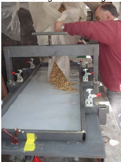
Fig 156: Elaboración seriada de paneles de cáscaras de maní a escala piloto. Fig. 156a: Dosificación de resina. Fig. 156b: Homogenización de resina y cáscaras de maní. Fig. 156c: Traslado de la mezcla
