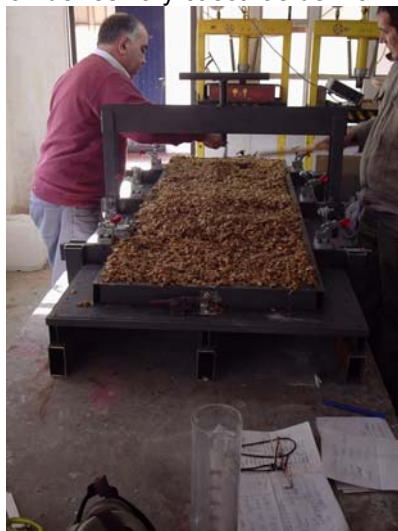
Fig 156: Elaboración seriada de paneles de cáscaras de maní a escala piloto. Fig. 156a: Dosificación de resina. Fig. 156b: Homogenización de resina y cáscaras de maní. Fig. 156c: Traslado de la mezcla
