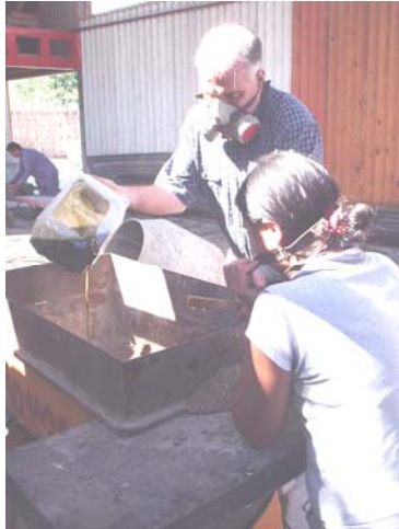
Fig 49 c, d y e: Homogeneización de cáscaras y resina
