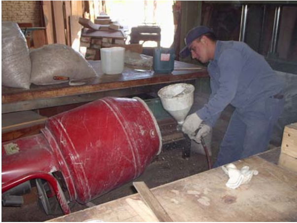
Fig 159: Elaboración experimental de tableros de cáscaras de maní en presa de platos calientes Fig 159c: Homogenización de cáscaras de maní con resina. Fig 159d: Pre- moldeo de mezcla
