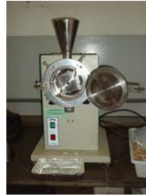
Fig. 43: Molino de cuchillas. 43a: Vista general 43 b: Vista de las cuchillas
