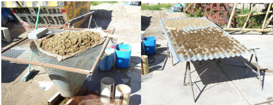
Fig. 55 Secado de cáscaras de maní después del lavado. Fig. 55a: Extracción total de agua y Fig 55b: Secado al sol
