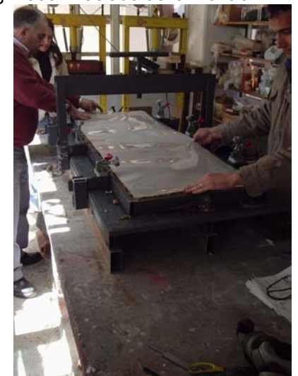
Fig 156: Elaboración seriada de paneles de cáscaras de maní a escala piloto. Fig. 156a: Dosificación de resina. Fig. 156b: Homogenización de resina y cáscaras de maní. Fig. 156c: Traslado de la mezcla
