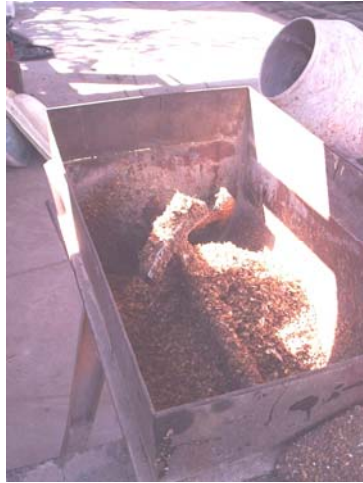
Fig 49 c, d y e: Homogeneización de cáscaras y resina
