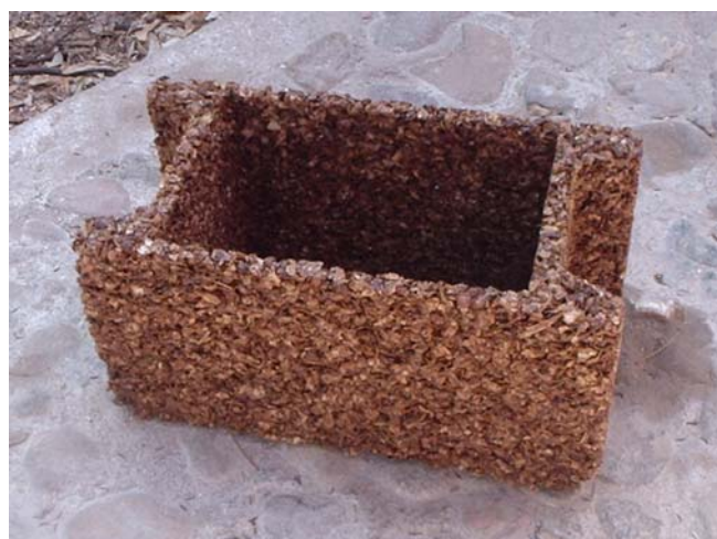
Figura 135: Bloque de cáscaras de maní y resina poliéster
