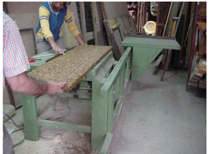
Fig. 136: Paneles livianos de cáscaras de maní y resina poliéster. Fig. 136a: Manipuleo y Fig. 136b: Corte de los paneles
