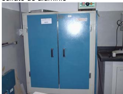
Fig. 48g: Secado en estufa de cáscaras impregnadas
