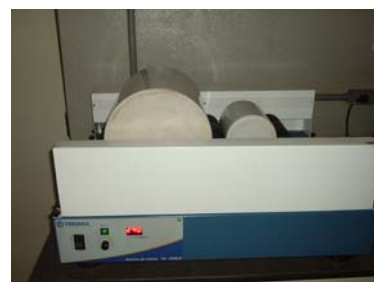
Fig. 41: Molino de bolas
