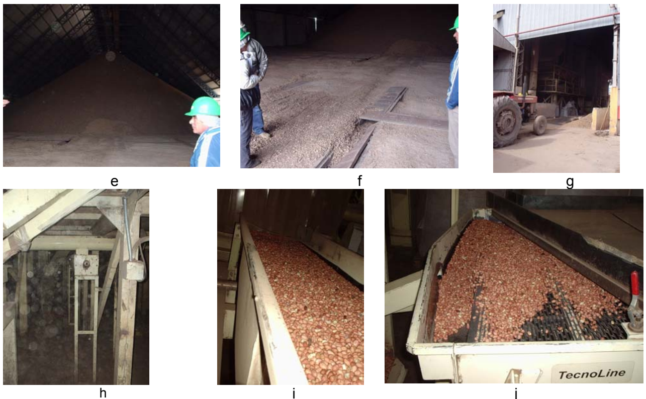
Fig 64: Procesamiento del maní en planta - Fig 64 e y f: Interior del silo donde se observa el volumen de acopio y canaletas para ventilación - Fig 64 g: Ingreso de maní a la planta de procesado - Fig. 64 h: Separación de la cáscara - Fig. 64 i y j: Clasificación de los granos de maní
