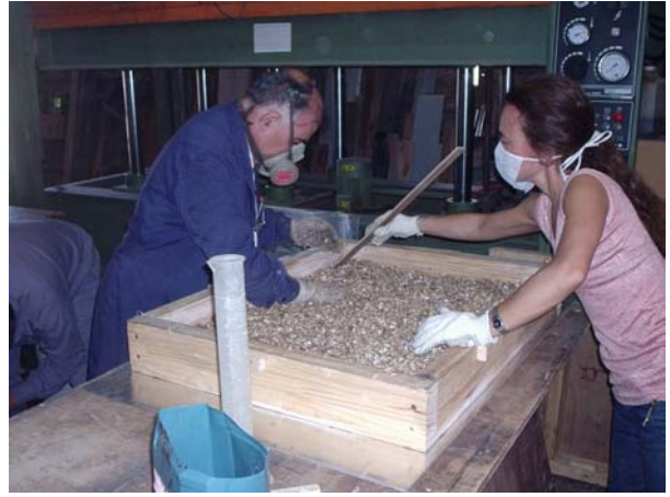
Fig 159: Elaboración experimental de tableros de cáscaras de maní en presa de platos calientes Fig 159c: Homogenización de cáscaras de maní con resina. Fig 159d: Pre- moldeo de mezcla
