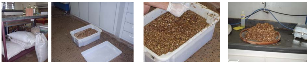
Fig. 39: Secuencia de lavado de las cáscaras de maní –39a: Cáscaras de maní en bolsas – 39 b: Inmersión en agua – 39 c; Agitación en agua – 39 d: Filtrado de agua
