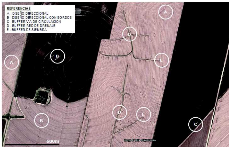
Figura 9. Estrategias locales de manejo en cuenca media. Control de las ramificaciones del carcazado incipiente, rectificado y consolidación de traza, empastado y suavizado de márgenes y entorno para desconcentrar caudales.
