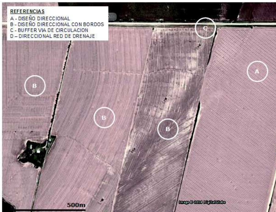
Figura 10. Estrategias locales de manejo en cuenca alta. Esquema de cultivos en contorno, para re-dirigir la escorrentía y albardonado intermedio para el frenado y retención de finos.
