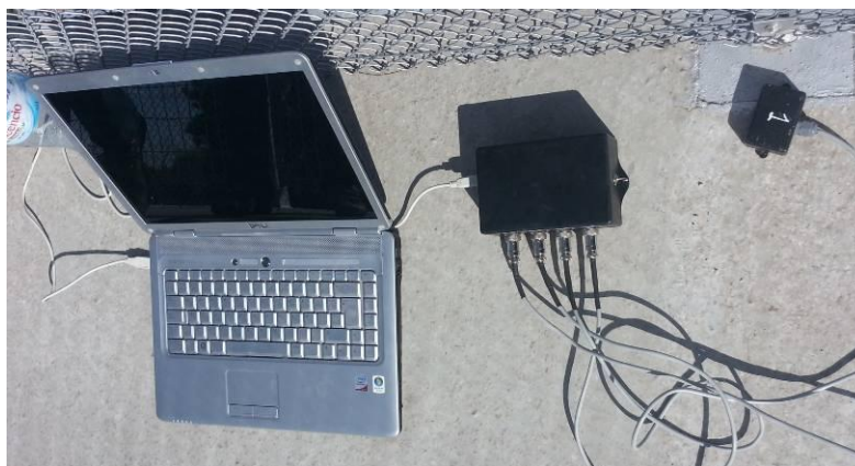
Figura 2. Sensores (acelerómetros) y Placa de Adquisición de Datos
