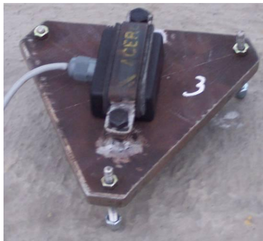
Figura 3. Sensores montados en bases metálicas
