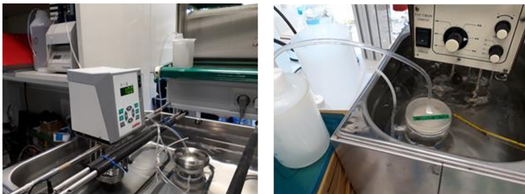
Figura 65 . Imágenes de las celdas Flow through para las pruebas de disolución a diferentes temperaturas. Izq.: celda en baño de 10 °C Der.: celda en baño de 50 °C.
