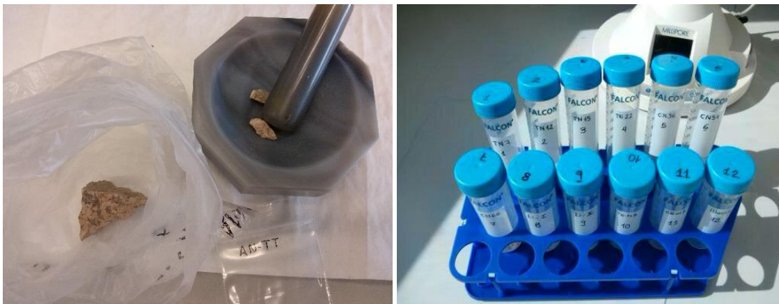
Figura 34. Izq.: molienda, en mortero de ágata, de una muestra de tosca del perfil del arroyo. Der.: muestras colocadas en tubos falcon listas para el SEP.
