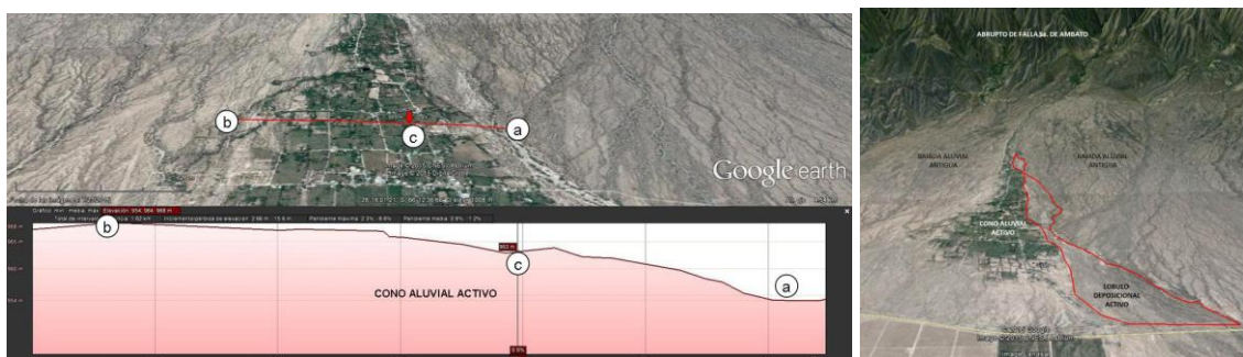
Fig.5. Perfil transversal en la zona media del abanico. (a) límite sur del cono aluvial-R. Sijan, (b) limite norte del cono aluvial y (c) canal antiguo coincidente con el trazo de la calle principal.
