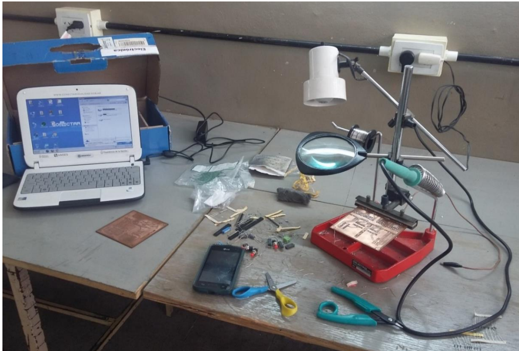
Figura 4.9. Mesa de trabajo de Esteban en el Laboratorio de Electricidad y Electrónica. Se puede observar una plaqueta de cobre sobre la mesa, junto a la netbook. La otra plaqueta se encuentra en el soporte con lupa y el soldador, para montar en la plaqueta los diferentes componentes electrónicos que están esparcidos en la mesa (Nota de campo, 18-10-2017).
